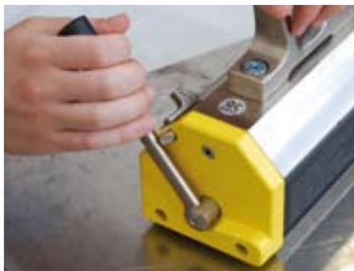
Активация устройства плавным движением рычага без рывка
