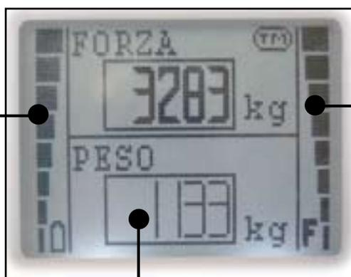
При включении ATS грузоподъемность подъемника и вес поднимаемого груза всякий раз сравниваются
