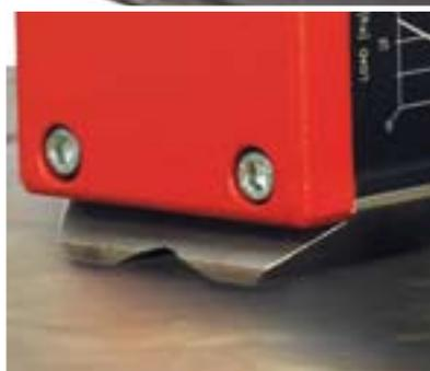
**MaxX TG с ячейкой MFB позволяет захватывать листы толщиной от 5 мм.**
